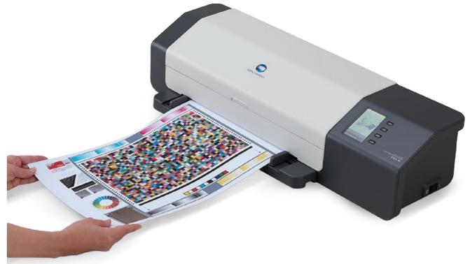
Para asegurar precisión, el escaneo se realiza como una serie de movimientos a alta velocidad que posiciona precisamente el sensor de color del FD-9 en cada punto de medición y detiene el movimiento con el suficiente tiempo para medir el punto antes de pasar al siguiente punto.
