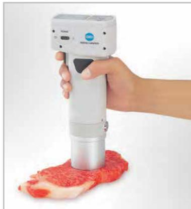
O CR-400 possui abertura de medição de  $\varnothing$  8 mm adequada para amostras homogêneas ou áreas pequenas.
