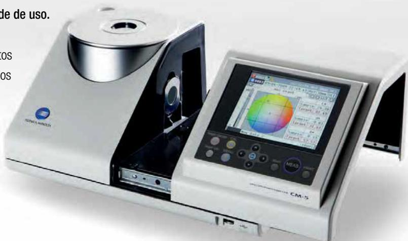
A abertura no topo permite a medição direta, por refletância, de amostras sólidas e com a utilização de uma Placa de Petri pode-se medir pós, pastas, grânulos e líquidos. Esse recurso permite a rápida troca de amostras em rotinas onde são necessários um grande número de medições. O CM-5 também possui uma câmara de transmitância para cubetas com passo ótico entre 2mm e 60mm para a medição de cor em amostras líquidas com diferentes níveis de transparência.
