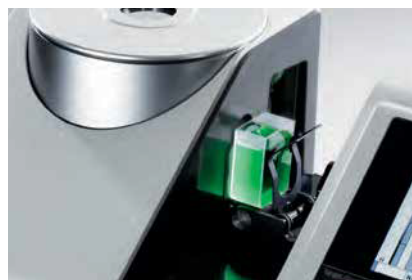
Medição por Transmitância no CM-5
