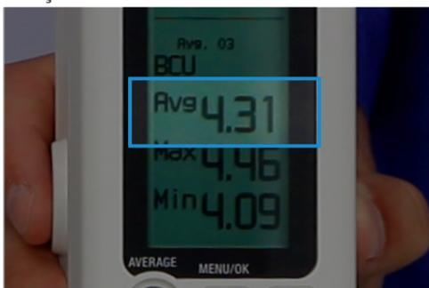
O BC-10 Plus realiza quantas medições forem necessárias e pode armazenar até 16 leituras simultaneamente. Para exibir a média das leituras armazenadas, basta pressionar o botão "Média".
