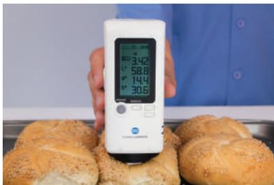
2. Usando o aplicativo de PC armazenado no BC-10 Plus, você pode configurar o instrumento para armazenar dados internamente (capacidade de memória: 1000 dados), transferir dados armazenados para o PC ou fazer medições no PC.
