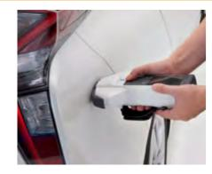
O corpo compacto (com alça de mão) pode ser manuseado de forma estável com uma ou duas mãos. Além disso, ele vem com recursos ideais para medição do exterior do veículo como proteção de borracha ao redor da abertura de medição, para proteger os objetos medidos contra riscos; suporte a Bluetooth® (opcional) para o envio de dados de medição para dispositivos remotos através de conexões sem fio.
