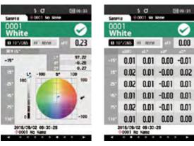
O CM-M6 possuiu uma tela colorida LCD de 3,5 polegadas que pode exibir os valores medidos numericamente e em gráficos coloridos para visualização mais fácil dos resultados. O CM-M6 é o espectrofotômetro compacto, leve e multiangular, que incorpora um novo sistema ótico patenteado de "dupla passagem", em diversas aplicações de medição.
