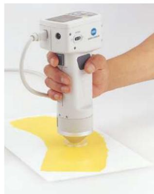
O cabeçote de medição pode ser utilizado independentemente do processador de dados. Isto é vantajoso quando a portabilidade é necessária ou o espaço disponível é limitado.
