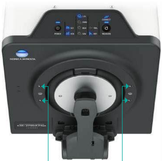
Quatro furos de montagem na parte frontal.
