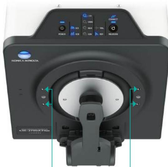
Orificios de montaje previamente roscados.
