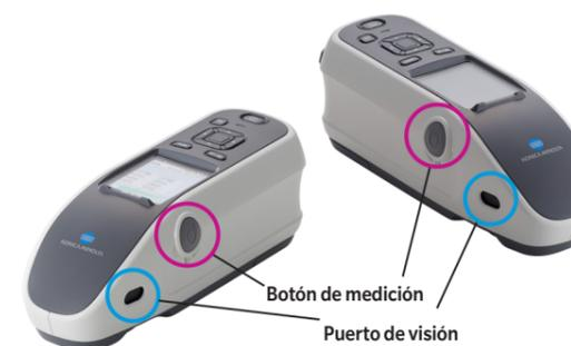
Al usar un sistema de iluminación/visión de 45°:0° con un formato de iluminación anillado que posee fuentes radialmente ubicadas a ciertos intervalos, el CM-25cG brinda datos estables mientras minimiza los efectos de rotación del instrumento. El sistema también brinda datos con alta precisión y repetitividad aún si hay una abertura pequeña entre la abertura medida y el objeto.
