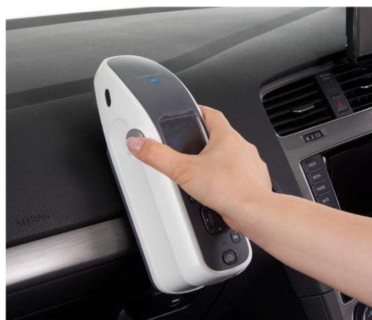
El CM-25cG mejora ampliamente la eficiencia en el trabajo al eliminar la necesidad de cambiar entre dos instrumentos – uno para color y otro para brillo- para cada medición, por lo que reduce el tiempo de toma, y brinda datos de medición de color y brillo desde el mismo punto exacto de medición para mayor control de calidad.
