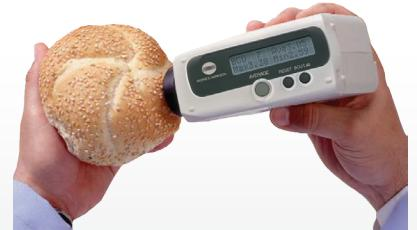
BC-10 Medidor de contraste para hornear
