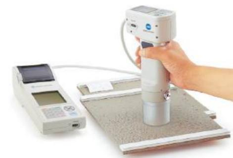
El compacto procesador de datos posee una impresora integrada para su utilización en cualquier lugar.
