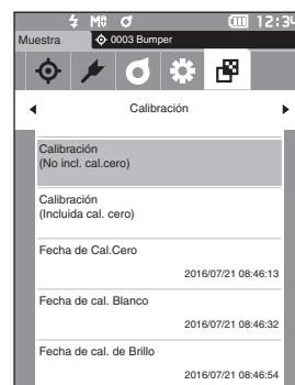
**2 Use [▲] o [▼] para mover el cursor a “Calibración (Incluida cal. cero)” y luego presione la tecla [Enter].**
