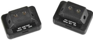
Los estándares se encuentran adjuntos magnéticamente al cabezal del instrumento para asegurar la calibración repetible.
