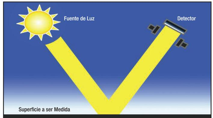
La unidad de medición para brillo es la Unidad de Brillo (GU) y la escala de medición a 60 grados es 0-1000GU en donde 0= una superficie completamente mate y 1000 = un espejo perfecto.
